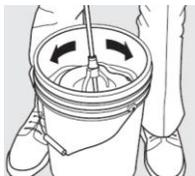
En un contenedor limpio con aproximadamente 5 litros de agua potable al tiempo, vacíe Baseflex marca DUROCK® en cantidad suficiente y mezclar. Poco a poco se agrega más polvo o agua hasta obtener una mezcla homogénea, con consistencia parecida al cemento convencional.
